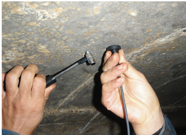
トンネル覆工厚さの測定状況と解析画面
